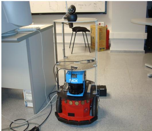
Figura 5.4: La figura rappresenta la vista frontale dell'architettura Hardware.
