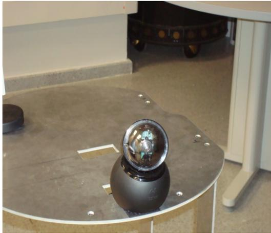
Figura 5.3: La figura presenta la camera ed il pan/tilt.
