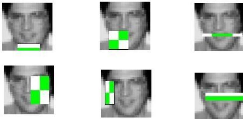
Figura 2.4: La Figura rappresenta le features ottenute dopo 4 livelli della cascata.
