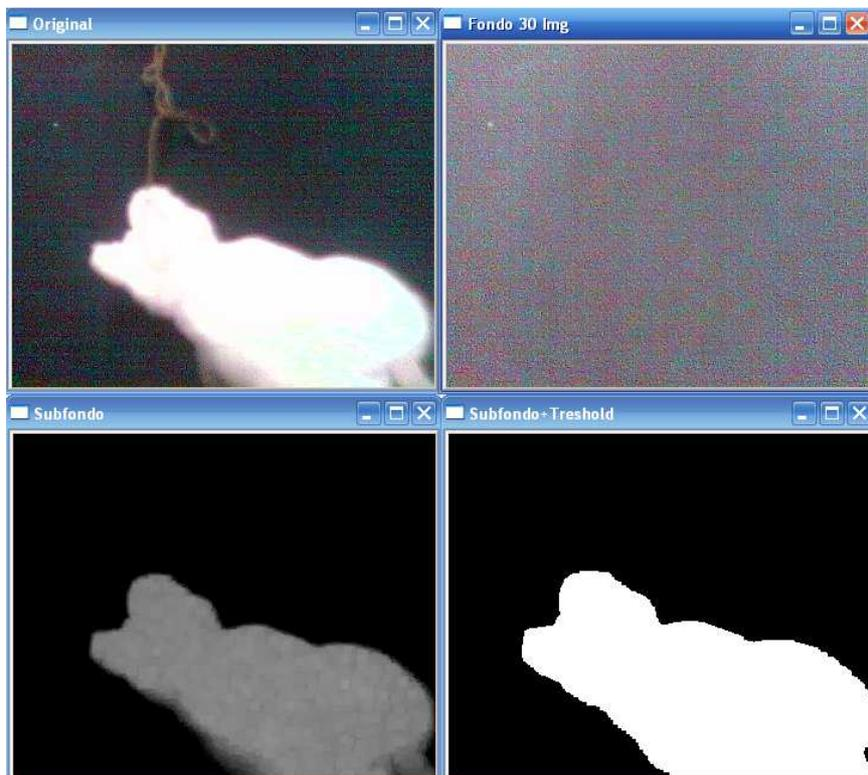
Figura 5. 3 Prueba del algoritmo con modelado de fondo de 30 imágenes
