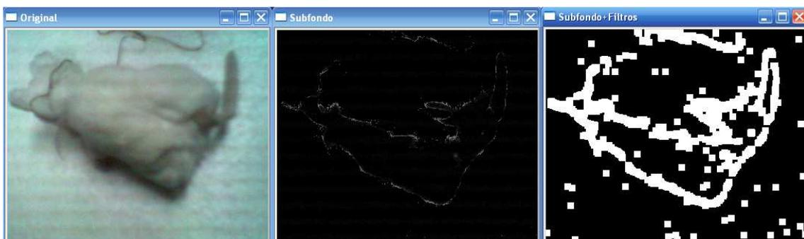
Figura 5. 2 Resultado del algoritmo con un objeto de bajo contraste
